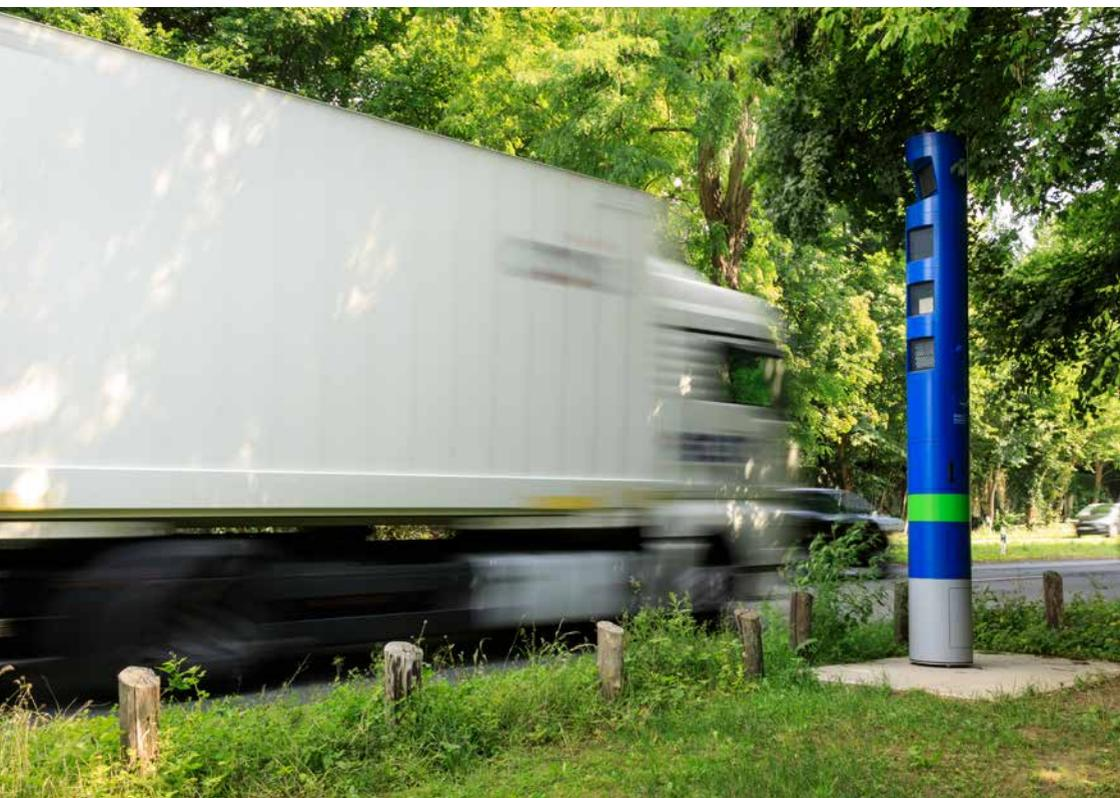
обзорный снимок транспортного средства, снимок сбоку и снимок номерного знака. Автомобильный прибор автоматически высылает настроенные, а также сохраненные в нем данные на контрольный столб. Ответственность за правильность высланных данных несет транспортное предприятие и водитель. Если все данные верны и оплата сбора была выполнена верно, то снимки удаляются.
